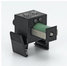
Électro-aimant pour le déclenchement d'un déplacement à un moment précis, par ex. à l'aide de l'adaptateur pour aimant de maintien avec déclencheur ( 336 25 ) ; avec noyau de fer à réglage axial pour la réduction des retards à l'aimantation. Se fixe sur un rail métallique de précision (par ex. 460 81 ) ; livré avec goupille pour le chariot pour rail.
