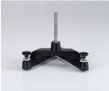
Axe vertical, à double roulement à billes dans pied en V ajustable (similaire à 300 01). Identique à la partie inférieure du gyroscope (348 20). Pour les expériences qui nécessitent un montage en rotation, par exemple pour l'étude de l'induction dans le champ magnétique terrestre.
