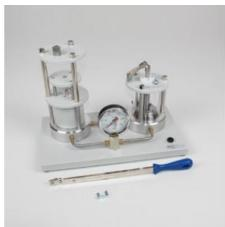
Pour la démonstration et l'étude quantitative de la transmission hydraulique des forces.
