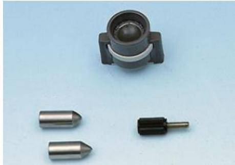
Billes d'acier montées dans un support à visser pour mesurer la dureté des métaux avec la presse hydraulique (36110).
