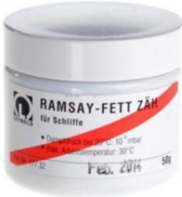
50 g, s'utilise à faible pression pour étanchéifier les rodages et les robinets; convient pour les expériences de décharge dans les gaz.
