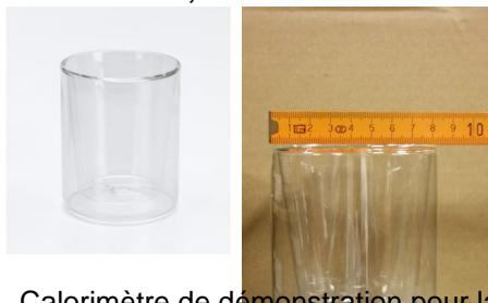
Calorimètre de démonstration pour la détermination des enthalpies de dissolution et de neutralisation.
