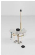
Pour déterminer l'équivalent électrique de la chaleur en chauffant électriquement des liquides non conducteurs dans le vase de Dewar de 250 ml ( 386 48 ).
