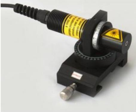
Diode laser sans autre composant optique, montée sur support tournant à l'horizontale et à la verticale pour l'étude de la distribution spatiale du rayonnement et de la polarisation d'une diode laser.
