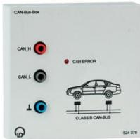
Se branche à un bus CAN (classe B) pour le relevé et l'exploitation du signal avec un oscilloscope
