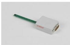
Pour la mesure de la densité du flux magnétique de petits champs en direction axiale avec CASSY ( 524013 , 524006 , 524005W , 524018 ) ou l'instrument de mesure universel Physique ( 531835 ). La sonde sert par exemple à mesurer la valeur et la direction du champ magnétique terrestre ( $40 \dots 60\mu T$ ) ou à mesurer le champ magnétique d'un conducteur traversé par un courant continu ou alternatif (Biot et Savart).
