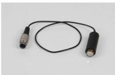
Tube compteur Geiger-Müller à auto-extinction, dans boîtier en plastique, avec fenêtre en mica très mince permettant aussi l'enregistrement d'un rayonnement  $\beta$  mou. Muni d'un câble solide. Livré avec capuchon de protection pour la fenêtre en mica.
