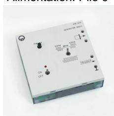
Générateur de signaux rectangulaires servant de module d'alimentation pour le transducteur d'ultrasons 40 kHz ( 416002 ).
