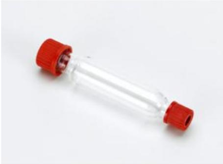
À remplir de granules de  $\text{CaCl}_2$  pour la combustion du butane.
