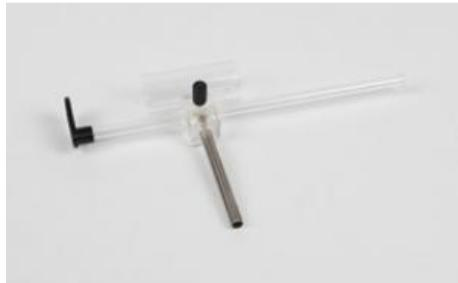
Pour seringue à gaz 100 ml. En plastique parfaitement transparent qui permet une lecture complète de l'échelle graduée de la seringue. La butée arrête le piston avant qu'il ne sorte de la seringue.
