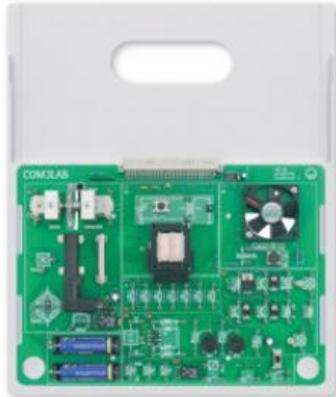
Ce cours COM3LAB traite des notions plus poussées de l'électricité et de l'électronique en automobile. Les propriétés physiques, chimiques et mathématiques de l'« électricité » permettent de bien comprendre le fonctionnement des circuits électriques d'un véhicule automobile. Des mesures diverses de même qu'une méthodologie de diagnostic et de dépannage complètent le tout.
