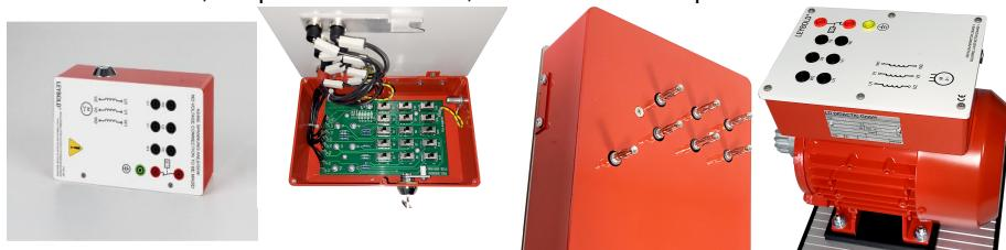
Le simulateur de défauts permet, en combinaison avec les moteurs asynchrones triphasés à cage d'écureuil, de simuler des défauts typiques tels que le défaut à la terre, l'interruption de l'enroulement, le défaut de spire, le défaut d'enroulement et la réponse du thermocontact.
