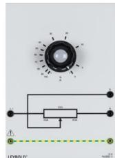
Rhéostat circulaire (enroulement à fil de section croissante) avec échelle 100 - 0 %.
