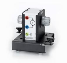
Sert à mesurer la vitesse de rotation des machines électriques des gammes 0,1 et 0,3 kW.
