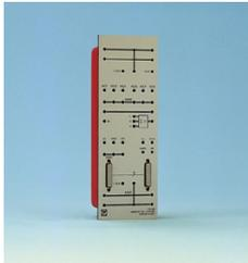
Cette plaque permet: la réalisation d'expériences de base avec le redresseur-commutateur de tension universel, la commande manuelle des transistors de puissance et/ou la sortie de tous les signaux d'état, des signaux de commande ainsi que des signaux de valeur réelle du courant avec isolement galvanique. Entrées/Sorties (niveau TTL):
