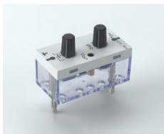
Élément enfichable STE 2/50 avec témoin du fonctionnement (LED) ainsi que 2 potentiomètres pour le réglage du rapport cyclique et de la fréquence pour la simulation du signal de vitesse de l'ABS ou de la durée d'injection Tinj pour les calculateurs automobile.
