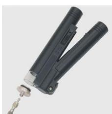
L'appareil est destiné à visualiser les défauts sur la surface de fibres optiques avec un diamètre de 2,3 mm important comme par ex. les fibres optiques HCS 200/230 ou PMMA 980/1000. Le microscope grossit 30 fois et dispose d'un éclairage intégré. L'éclairage se met automatiquement en route à l'ouverture du microscope.
