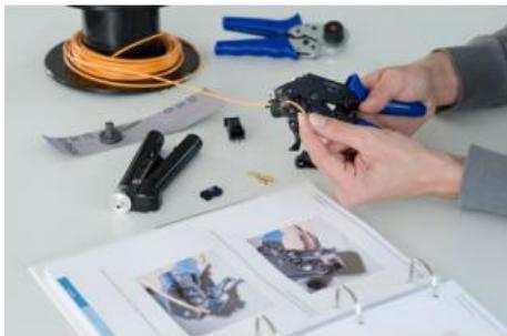
Les appareils et kits de matériel présentés ici permettent aux élèves de fabriquer des fibres optiques typiquement utilisées en automobile et à l'enseignant, d'évaluer les résultats.
