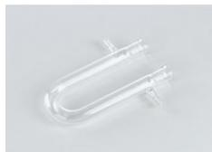
Pour l'électrolyse et le séchage des gaz
