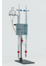
Voltamètre d'Hofmann, pour l'électrolyse de l'eau.
