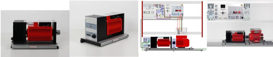
Le dynamomètre électrique est le système de base du système de test de machines pour l'enregistrement de la courbe des machines électriques de la catégorie 0,3•kW dans les quatre quadrants de fonctionnement.
