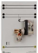
Commande proportionnelle, ne requierant aucun service d'entretien, pour la connexion directe au bus EIB avec moteur, organe de transmission, reconnaissance de course, électronique de communication et de commande. Boîtier transparent pour raisons didactiques. Alimentation bus EIB. Une coupe de vanne thermostatique illustre le fonctionnement de l'électromoteur.
