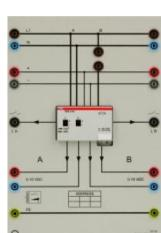
Destiné spécialement à commuter et à faire varier l'intensité lumineuse des tubes fluorescents par l'intermédiaire du bus EIB (bus d'installation européen).
