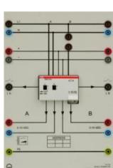
Destiné spécialement à commuter et à faire varier l'intensité lumineuse des tubes fluorescents par l'intermédiaire du bus EI (bus d'installation européen).
