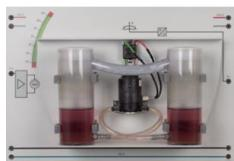
Il sert de modèle de navire porte-conteneurs pour l'étude des phénomènes d'instabilité d'un système non-linéaire, par ex. régulation de la position horizontal d'un navire.
