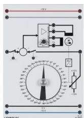
Combinaison potentiomètre-moteur avec transmission, amplificateur de réglage et poulie avec pignon pour courroie dentée.
