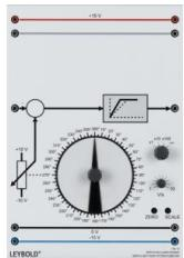
Transmetteur de position avec disque rotative gradué en angle pour une utilisation dans des systèmes asservis. Avec n?ud additionneur d'entrée pour l'application de grandeurs perturbatrices ou la modification de la valeur de consigne et limiteur de croissance pouvant être mis en circuit avec des temps de montée de 1 V/s à 1000 V/s.
