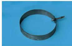
Avec fiche de 4 mm pour le montage sur un chariot pour rail ( 337 110 ). Convient notamment pour l'étude du choc, par ex. avec la caméra VidéoCom ( 337 47USB ).
