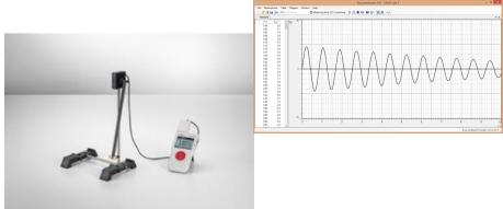
Dans l'expérience P1.5.1.3 on étudie l'oscillation d'un pendule à tige qui représente un pendule de physique simple.
