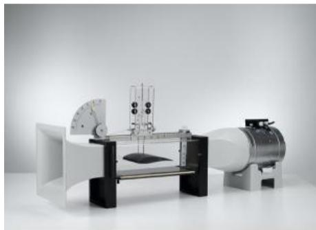
Au cours de l'expérience P1.8.7.1, on mesure la traînée aérodynamique FW et la poussée verticale FA d'une surface portante en fonction de l'angle d'attaque à de l'aile par rapport à la direction du courant. On reporte dans un diagramme polaire FW en fonction de FA avec l'angle d'attaque à comme paramètre. On peut par exemple déduire de ce diagramme polaire l'angle d'attaque optimal.
