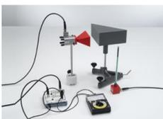
Dans l'expérience P3.7.4.6, on étudie la réflexion totale de micro-ondes sur un milieu optiquement assez fin. La mécanique des ondes dit que l'onde réfléchie pénètre le milieu optiquement plus fin sur 3 ou 4 longueurs d'ondes pour se propager le long de la surface limite en tant qu'onde de surface.
