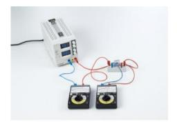
P4.1.2.2 Relevé de la caractéristique courant / tension d'un varistor
