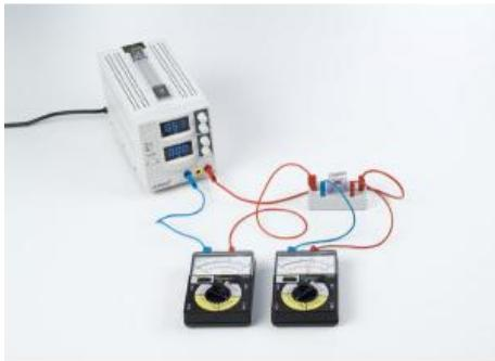
Dans l'expérience P4.1.2.2, on trace la caractéristique courant-tension d'une varistance (VDR résistance dépendant de la tension).
