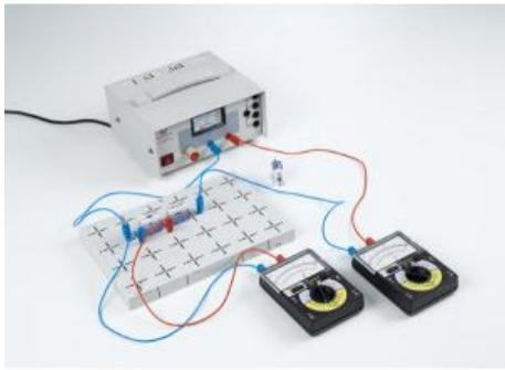
Dans l'expérience P4.1.3.1, on mesure puis on trace manuellement point par point la caractéristique d'une diode Si puis celle d'une diode Ge.
