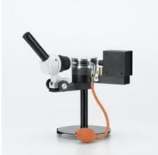
Pour la mise en évidence de la quantification des charges électriques et la définition de la charge élémentaire, dispositif compact composé d'un condensateur à plaques sous cache en plastique, d'un microscope de mesure avec angle d'observation oblique, d'un dispositif d'éclairage et d'un atomiseur d'huile ( 685 75 ) avec poire en caoutchouc ( 667 241 ), sur support (trépied) ; livré avec huile dans flacon en plastique ( 685 78 ).
