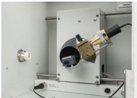
Dans l'expérience P6.3.7.1, la variation de la longueur d'onde par la dispersion du Compton à l'aide d'un tube compteur Geiger-Müller est démontrée.
