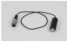
Tube compteur Geiger-Müller à auto-extinction, dans boîtier en plastique, avec fenêtre en mica très mince permettant aussi l'enregistrement d'un rayonnement  $\beta$  mou. Muni d'un câble solide. Livré avec capuchon de protection pour la fenêtre en mica.
