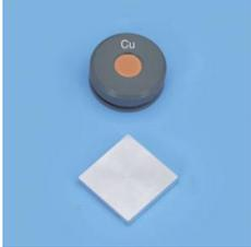
Pour l'appareil à rayons X (554 801) pour l'étude de l'effet Compton par transmission en fonction de la longueur d'onde, suivant le positionnement du filtre Cu devant ou derrière le diffuseur en aluminium avec corps dispersant en aluminium et filtre en cuivre dans montage.
