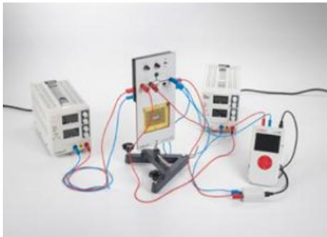
Dans l'expérience P7.2.1.5, on mesure à titre de comparaison la conductivité électrique du germanium non dopé en fonction de la température.
