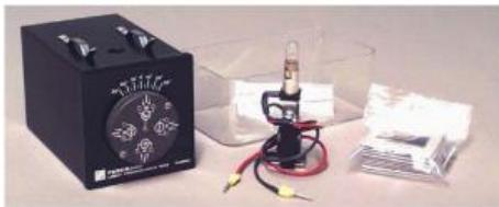
Le kit Transducteur de lumière TK2841L contient un dispositif de détection optique, trois dispositifs photoélectriques et une sélection de filtres optiques.
