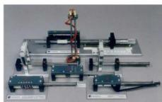
Le Kit transducteurs électromécaniques TK2941E est composé de six transducteurs de déplacement linéaire. C'est le kit de base pour la gamme TK2942 et introduit quelques principes de base sur les transducteurs et les exigences d'instrumentation associées.
